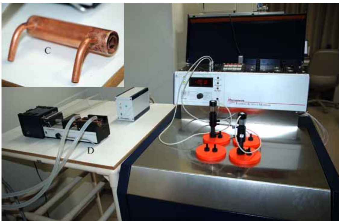
Fig. 2 シリンジポンプ部分の恒温化
